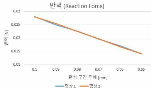
[그림 2] 탄성 구간 두께 변화에 따른 반력(Reaction Force) 그래프
